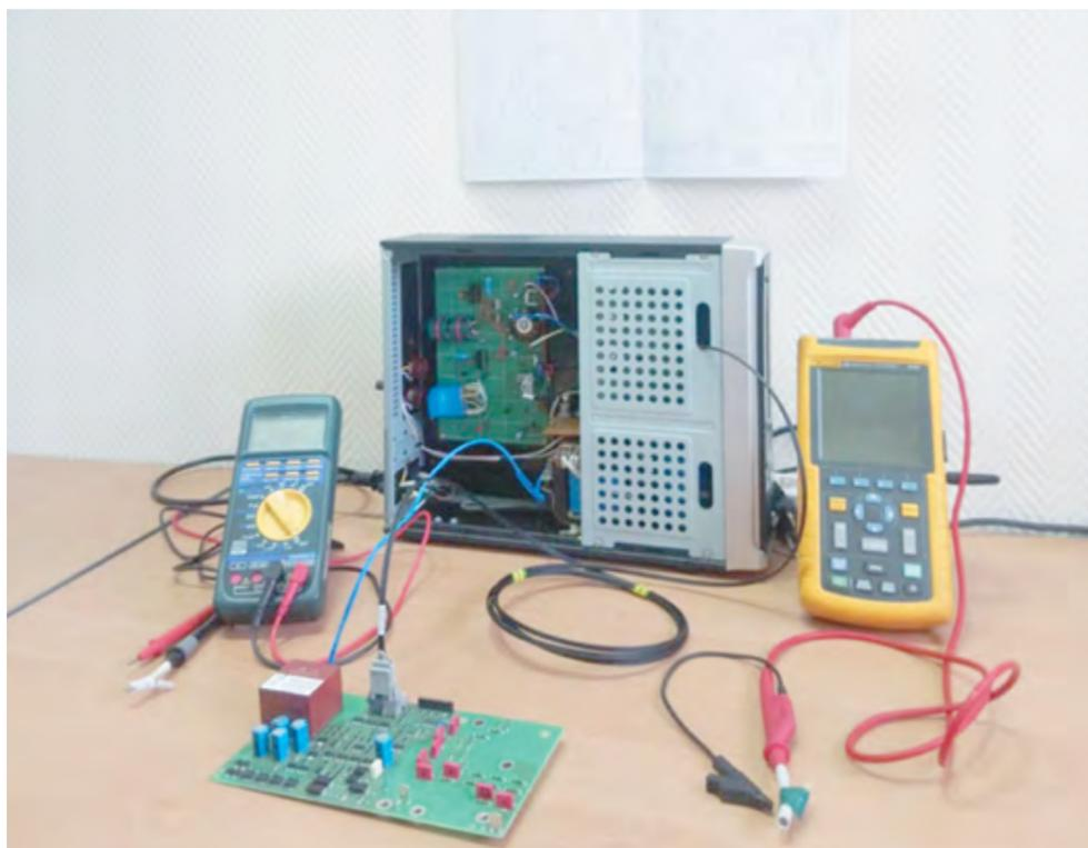
Процесс диагностики платы управления на электроприводных газоперекачивающих агрегатах
